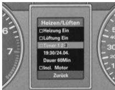
Дисплей FIS приборной доски: меню Heizen/Luften, выбран Timer 3
