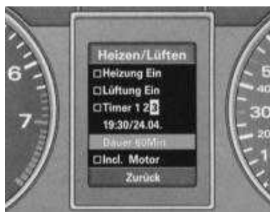
Дисплей FIS приборной доски: меню Hizen/Luften, установлена длительность работы для Timer 3
