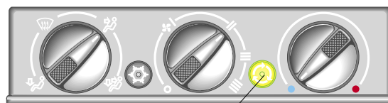
Клавиша рециркуляции – климатическая установка с ручным управлением
