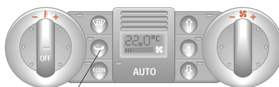
Клавиша рециркуляции – автоматическая климатическая установка
