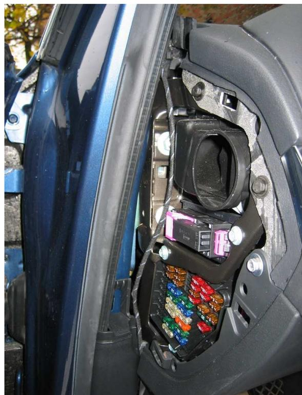
Schalttafelabdeckung unten im Fahrerfußraum demontiert werden. Hierzu die drei Schrauben (zwei unten, eine links) herausschrauben und die Abdeckung an der Oberkante anfassen und nach hinten abziehen. Vor dem komplett Ausbau den Diagnosestecker ausclippen und zusätzliche Steckverbindungen lösen.
