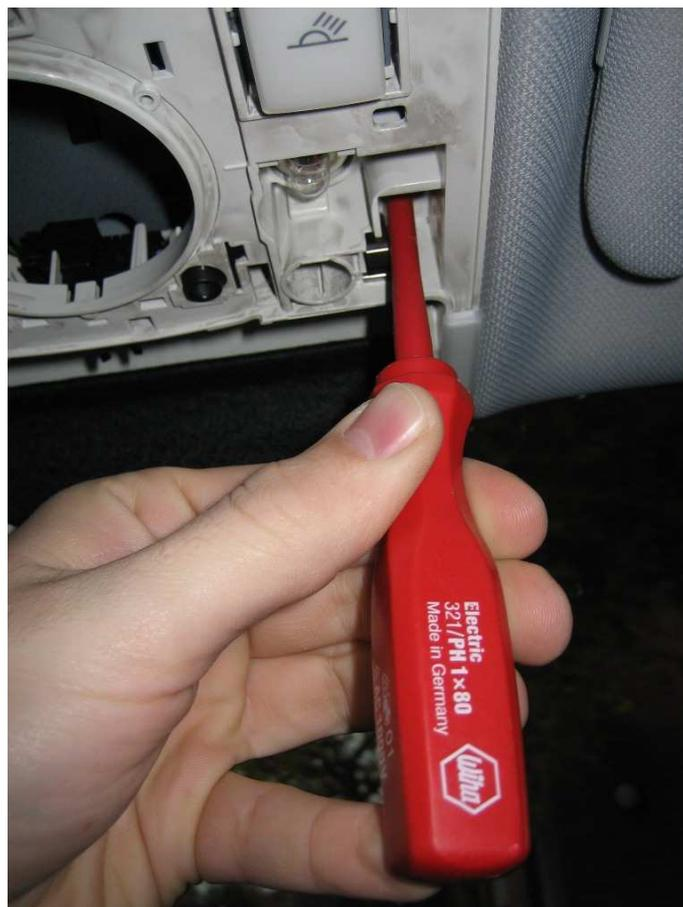
Anschließend die Innenleuchte vorsichtig vorne nach unten schwenken und aus der Dachverkleidung nehmen. Die elektrischen Steckverbindungen für Strom und eventuell verbaute Mikrofone müssen gelöst werden.
