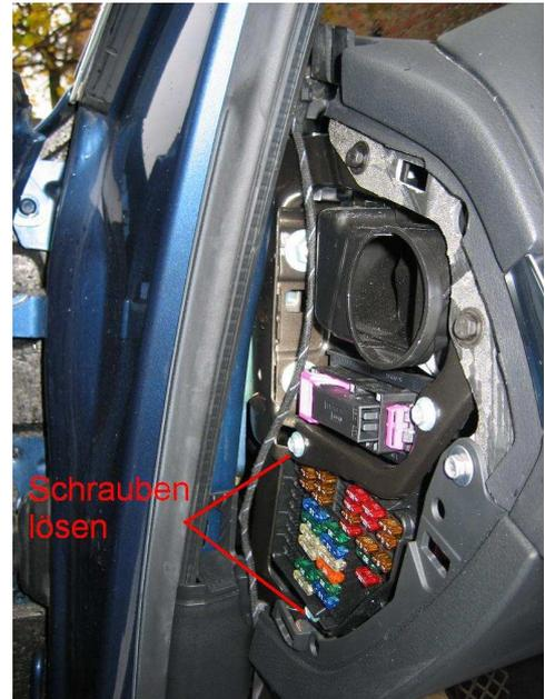
Sollte der Anschluss der Sicherung 5 bereits belegt sein so muss das Kabelende mit angelötet werden. Ich habe dazu das vorhandene Kabel durchtrennt und beide Enden mit einem Stoßverbinder wieder verbunden. Das Kabel vom Innenspiegel habe ich ebenfalls mit in den Stoßverbinder gelegt. Den Stoßverbinder habe ich nach dem Zusammendrücken heiß gemacht damit der Schrumpfschlauch die Kabelenden isoliert.
