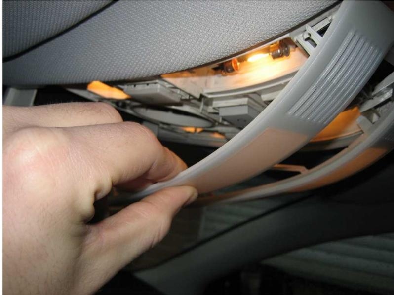
Um die Leseleuchte nun aus dem Dachhimmel auszubauen müssen die beiden Schrauben (links/ rechts) entfernt werden.
