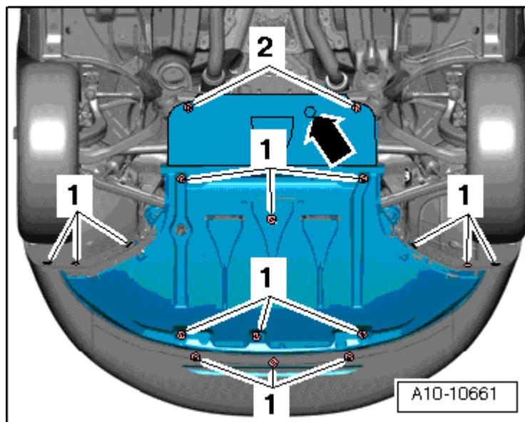
– Снять шумоизоляционный экран -1- в правой колесной арке.
